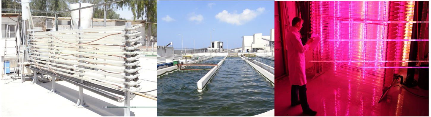
Figur 2: Produktion af mikroalger med forskellige teknikker. Yderst til højre og venstre to forskellige fotobioreaktorer, i midten en race a pond.
